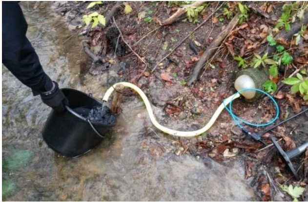
Figur 12. Punktmåling af drænvandføring ved brug af "snabelmetoden" (Foto: Bioscience, Aarhus Universitet)
